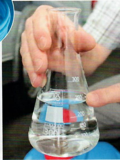
Zur Erstentkeimung kommt ein Prozent Monerablue pro Liter Wasser in den Tank. Für die Erhaltungsdosis genügen bei jeder weiteren Tankfüllung 0,2 Prozent.
