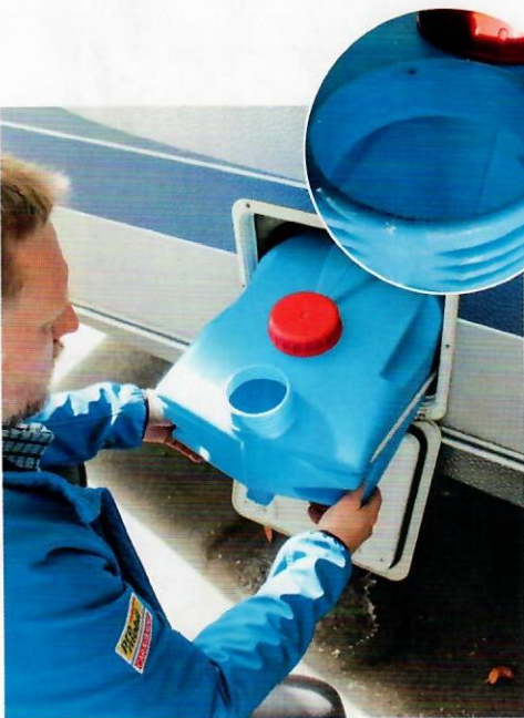
Vor dem Desinfektionsprozess schadet es nicht, Tank und Öffnung, soweit möglich, mit Wasser, Bürste und Lappen mechanisch zu reinigen. Anschließend wird das „Schmutzwasser“ abgelassen.
