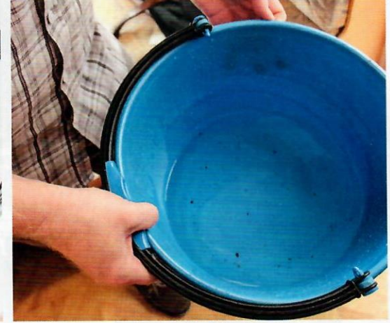
Das Ergebnis nach drei Spüldurchläufen: Ablagerungen in Leitungen und Schläuchen lösen sich. Nicht sichtbar sind Bakterien und Krankheitserreger, die das geruch- und geschmacklose Monerablue abtöten soll.
